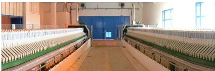
chaulées et déshydratées par filtre presse. Les terres de décantation sont évacuées par vis convoyeuse et transportées par camion vers les parcelles agricoles pour être valorisées.
